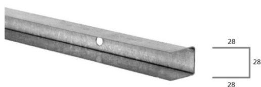
Guida a "U" per cartongesso 6/10 da mt.3 033408 cm.28x28x28 da mt.4 033409 cm.28x28x28
